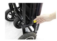
Sujete la columna de dirección y localice la pequeña palanca amarilla en el lateral del Lite y tire de ella para desbloquear el conjunto de la rueda delantera.
