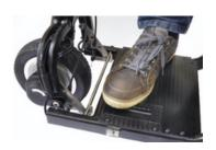
Asegúrese de que los pestillos de bloqueo están bien sujetos a la barra de acero presionando con el pie sobre el reposapiés.
