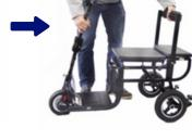
Sujete la columna de dirección y el respaldo del asiento y sepárelos. El scooter se desplegará y oirás un clic cuando se bloquee en su posición abierta.
