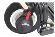
Compruebe que la palanca roja del freno magnético está en la posición de BLOQUEADO para engranar el motor.
