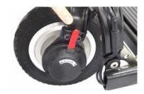
Assegure-se de que os fechos de bloqueio estão bem fixos à barra de aço, pressionando o pé sobre a placa de pé.
