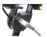
Para carregar, ligue o cabo de alimentação à porta de carregamento situada na parte superior da coluna de direção.
