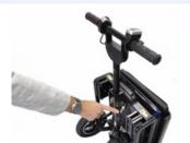
Para transformar a scooter em bagagem rolante, puxe o guiador para cima e prima a alavanca amarela, fixando-a no segundo ponto de paragem.
