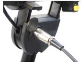
Zum Aufladen schließen Sie das Stromversorgungska- bel an den Ladeanschluss oben an der Lenksäule an.
