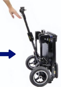
Drücken Sie auf die gelbe Verriegelung, um die Lenksäule zu entriegeln, so dass sie frei schwingen kann.
