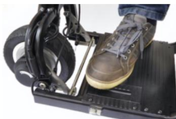
Vergewissern Sie sich, dass die Verriegelungsklinken sicher an der Stahlstange befestigt sind, indem Sie mit dem Fuß auf die Fußplatte drücken.
