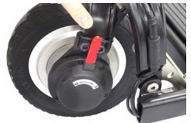
Vergewissern Sie sich, dass der rote Magnetbremshebel in der Position VERRIEGELT steht, um den Motor einzuschalten.
