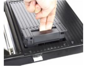
Um den Akku zu entfernen, heben Sie die Verriegelung an und ziehen Sie ihn vorsichtig nach oben.
