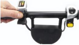
Um den Roller einzuschalten, drücken Sie die graue Taste unter der Batterieanzeige. Wählen Sie (D) für Fahren oder (R) für Rückwärtsfahren, und drücken Sie dann den Daumengashebel, um loszufahren.
