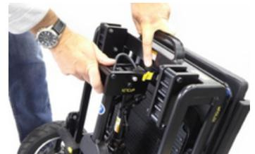
Fassen Sie den Scooter an der Lenksäule und am Tragegriff und heben Sie den Sitzrahmen in eine aufrechte Position.
