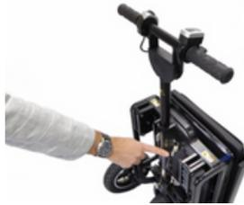
Um den Scooter in ein Rollgepäck zu verwandeln, ziehen Sie den Lenker nach oben und drücken Sie den gelben Hebel, um ihn am zweiten Anschlagpunkt zu sichern.
