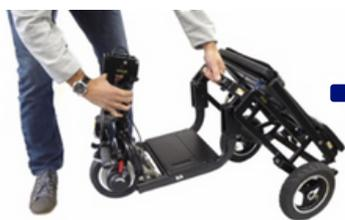
Saisissez le scooter par la colonne de direction et la poignée de transport et soulevez le cadre du siège en position verticale.
