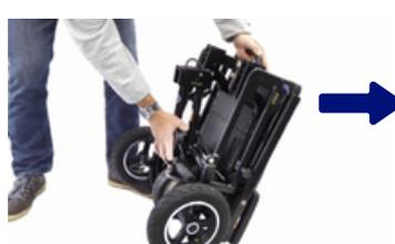
Poussez la colonne de direction vers l'intérieur jusqu'à ce que la roue avant et le loquet s'enclenchent fermement en place. Poussez ensuite fermement la colonne pour la bloquer contre le châssis.
