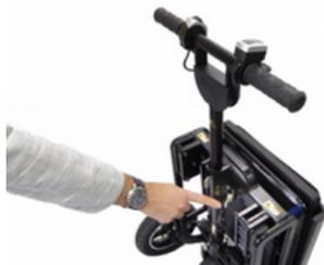
**Pour transformer le scooter en bagage à roulettes**, tirez le guidon vers le haut et appuyez sur le levier jaune, en le fixant sur le deuxième point d'arrêt.
