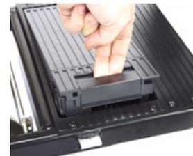
**Pour retirer la batterie**, soulevez le loquet et tirez-la délicatement vers le haut. Le port de chargement est situé sur le côté de la batterie.
