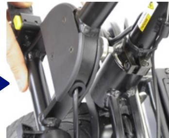
Appuyez sur le petit loquet jaune situé à l'avant de la colonne de direction et maintenez-le enfoncé, puis rabattez-le vers le bas jusqu'à ce que le guidon s'enclenche, sécurisé par l'aimant.
