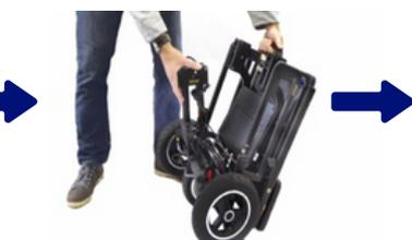
Inclinez le scooter vers l'arrière (vous pouvez utiliser votre pied derrière la roue pour le stabiliser si nécessaire), en l'équilibrant sur les roulettes.
