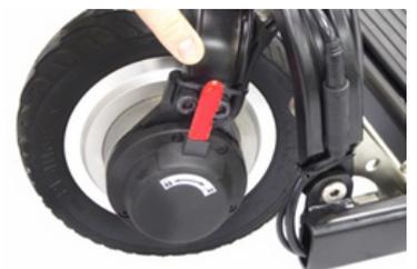
Vérifiez que le levier rouge du frein magnétique est en position verrouillée pour engager le moteur.
