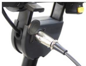
**Pour charger**, connectez le câble d'alimentation au port de charge situé en haut de la colonne de direction.
